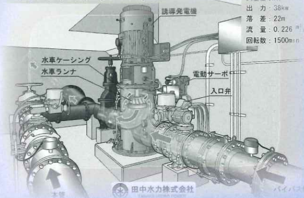
立軸インライン式フランシス水車
